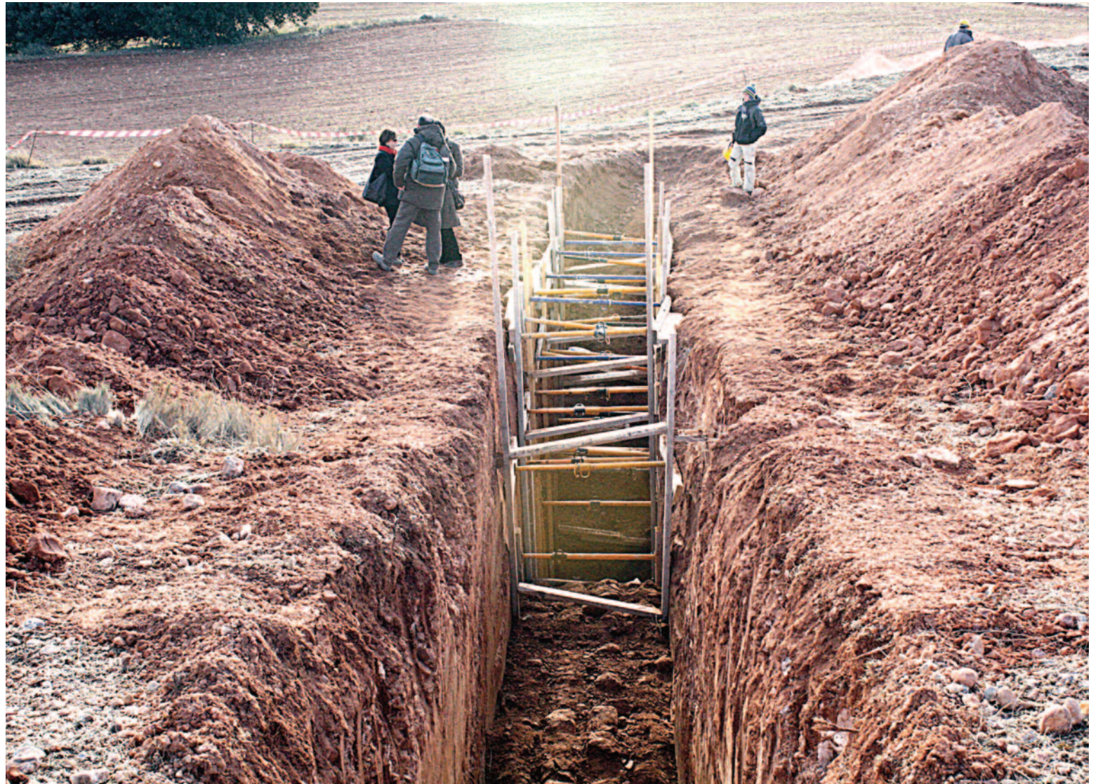
Trincheras abiertas en Concud para investigar el comportamiento de la falla, en un trabajo de campo de enero de 2009. Archivo
