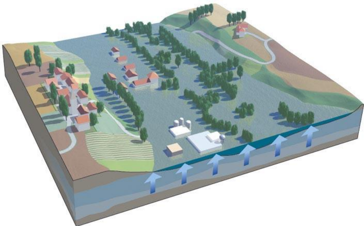
Remontée de nappe
